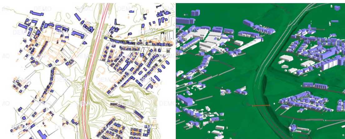
Imagem 12: Extrato da planimetria, com edifícios, linhas de berma, estradas, muros, vedações e outros e respetivo 3D.
